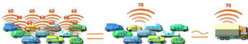
Figure 5 : addition de 10 sources sonores de même intensité (source : www.bruitparif.com )
